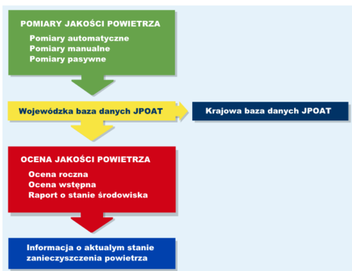
Rysunek 3.25 Schemat funkcjonowaniu monitoringu ochrony powietrza
